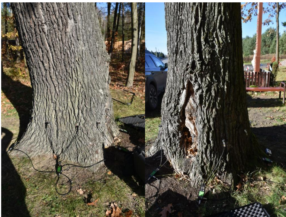
Fot.5-6. Rozmieszczenie czujników urządzenia ARBORSONIC 3D na pniu drzewa
